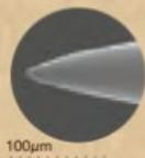
これまでの研削工程に加え、「先端研磨加工」技術の確立により、鍼尖が丸い鍼を実現しました。
